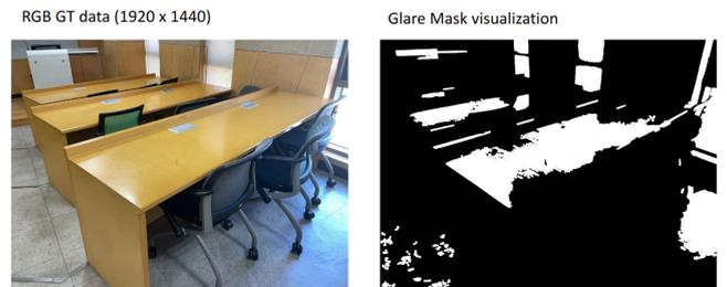
그림 5. Threshold 기반의 Glare 영역 추출
